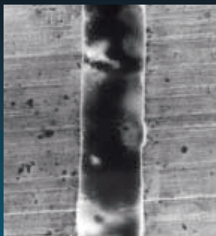
Laser Screenの表面。 エッジがシャープで表面はなめらかです。 (倍率 \times 260、孔径100 \mu m)
