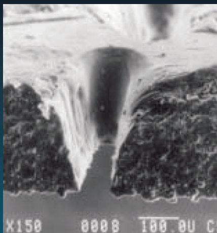
Laser Screenの断面写真。 孔はテーパー状になっておりエッジも非常にシャープです。 (倍率 \times 150、孔径100 \mu m)
