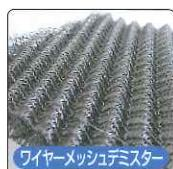
気体中に存在する液体の微粒子（ミスト）を気体中から分離除去する用途に使用される。その使用分野は、石油精製・石油化学・化学工業全般・発電・製紙・精糖・海水淡水化（造水）公害防止など多岐にわたります。
