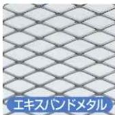
鉄やステンレスなどの板を引き延ばし切断しているため軽量で強度があり、表面の隆起により滑り止めの働きもあります。自動車車体用機器、通信機器外装、冷暖房装置、換気通風各部、フェンス等の用途があります。
