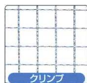
縦に波形の屈曲を施し、縦・横線をはめ合わせて作った金網で、縦・横線は互いに強固に組み合わされているため、網目は正しく保持されています。身近なものではバーベキューの網に使われているほか、ふるい分け用・ろ過用・乾燥用・補強用・間仕切り用・保安用・その他広い範囲に利用されています。
