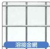
普通鉄線やステンレス線を使用し、縦線と横線を直角に配列させ、その交点を電気抵抗溶接して製造する金網。道路・建築等あらゆるコンクリート工事及びコンクリート製品の補強鉄筋・フェンスに利用されています。
