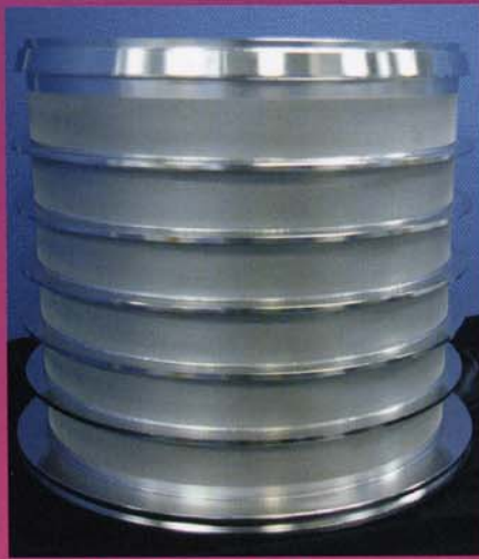
▲ 制浆和造纸用筛鼓 内径：φ381mm、孔径：φ0.1mm 板厚：T1.5mm 孔数：310万孔目、材质：SUS316L
