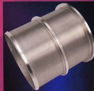
▲ 用于制造玻璃纤维的整流装置 外径：320mmφ、孔径：0.53mmφ 板厚：1.52mm、开孔率：5% 40°斜孔、材质：SUS304
