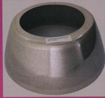
▲ 用于制造玻璃纤维的整流装置 外径：320mmφ、孔径：0.53mmφ 板厚：1.52mm、开孔率：5% 40°斜孔、材质：SUS304
