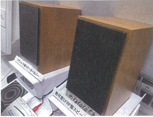
図2 据え置き型スピーカーに付けたスピーカーカバー CFRP製(手前)スピーカーカバーを付けたスピーカーから流れた音はクリアに聞こえる。これに対し、SUS304製(奥)のそれはこもって聞こえる。
