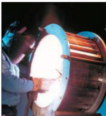
焊接用于矿物加工厂的重型激光滤网结构。
