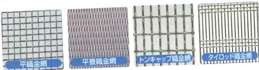
最も一般的な金網。織り物のように縦、横に金属線を交差させて作ります。平織、綾織、平畠織、クリンプ織、トンキヤップ織、フラットトップ織、タイロッド織など織り方や使用目的によりいくつかの種類に分けられます。ふるい分け・ろ過用・精錬用・乾燥用・補強用・触媒用・コン
