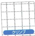
なみがたくつきぎほどこ 線に波形の屈曲を施し、縦・横線をはめ合わせて作った金網で、縦・横線は互いに強固に組み合わされているため、網目は正しく保持されています。身近なものではバーベキューの網に使われているほか、ふるい分け用・ろ過用・乾燥用・補強用・間仕切り用・保安用・その他広い範囲に利用されています。
