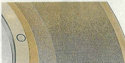
微細な穴がびっしりと並ぶプラスチック再生用フィルター(奥谷金網製作所提供)
