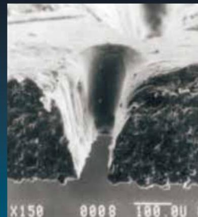
Laser Screenの断面写真。孔はテーパー状になっておりエッジも非常にシャープです。(倍率 $\times 150$ 、孔径 $100\mu\text{m}$ )
