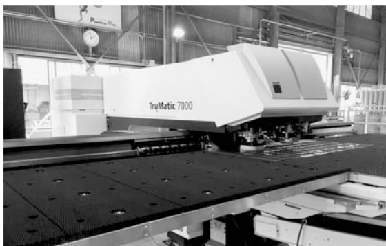
第2工場に導入したレーザーパンチング複合機
