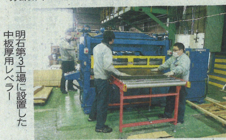
明石第1工場に導入した薄一中板厚用レベラー
