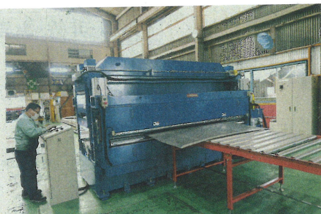
明石第1工場に導入した薄一中板厚用レベラー
